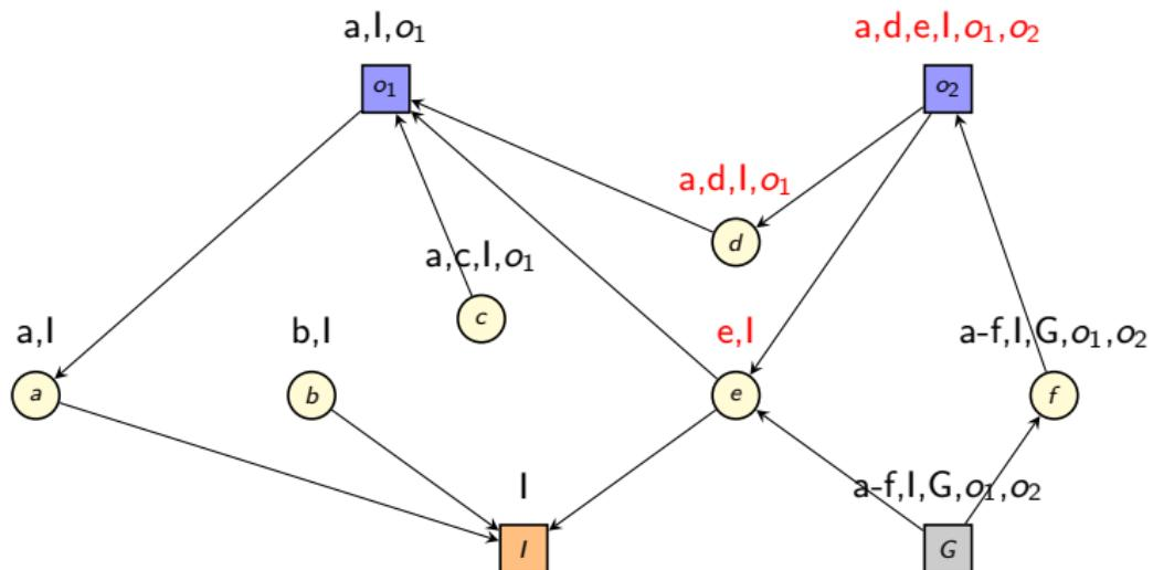
$$LM(o_2) = \{o_2\} \cup LM(d) \cup LM(e)$$
