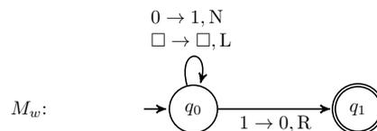
Auf Eingabe  $w$  ersetzt  $M_w$  die erste 1 durch eine 0, bewegt den Kopf nach rechts und geht in einen Endzustand. Die Maschine hält also an und es folgt  $w \in K$ .
