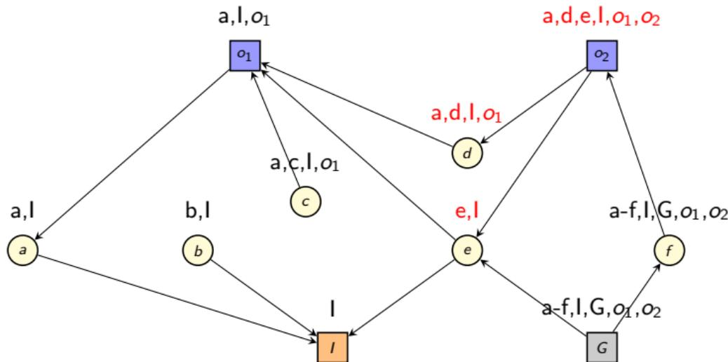
$$LM(o_2) = \{o_2\} \cup LM(d) \cup LM(e)$$
